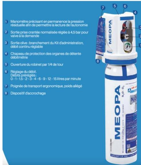
Figure 9 : Bouteille B5 PRESENCE avec manodétendeur intégré
