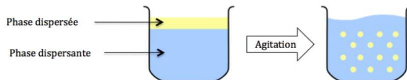
Figure 11 : Fabrication d'une émulsion
