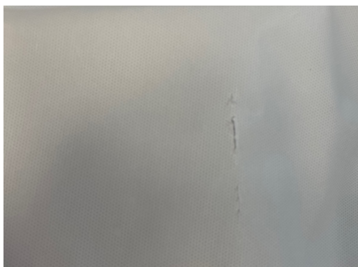
Figure 2 : Emballage d'un DMR présentant une déchirure causée par le système de stockage
