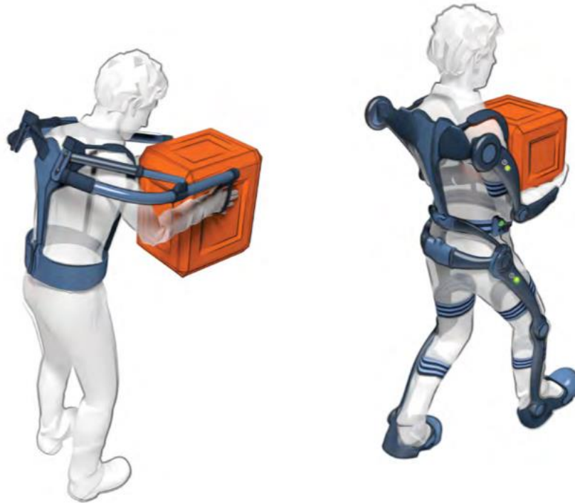
21 : Exemples d'exosquelettes utilisés dans le milieu du travail pour limiter les efforts physiques et ainsi réduire les risques de lombalgie
