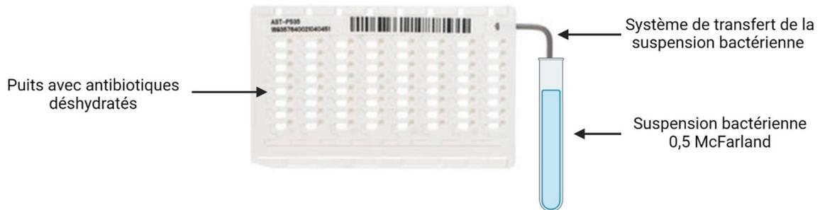
Figure 25 : Principe d'automatisation de la microdilution en milieu liquide (carte Vitek 2)
