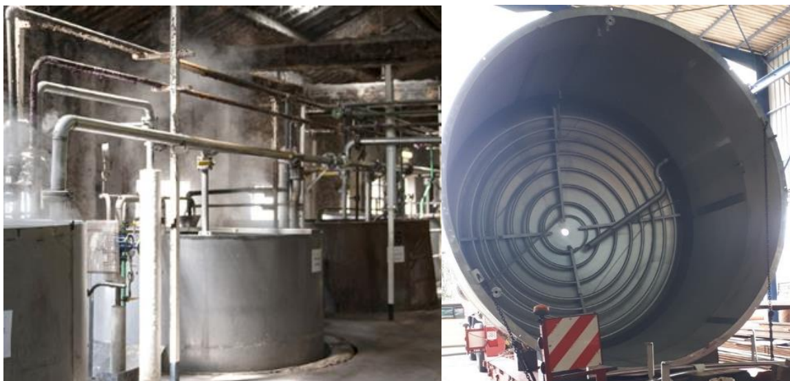
Figure 35 : Chaudron à vapeur utilisé dans la saponification artisanale (149), (150)
