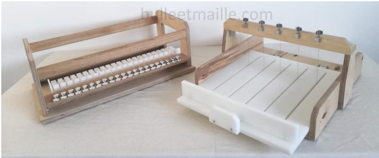
Figure 55 : Découpeur musical pour savon individuel (gauche) et découpeur savon multibarres (droite) en bois et PEHD (178)
