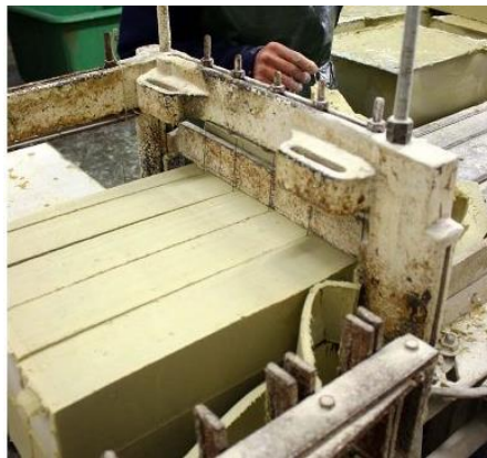
Figure 42 : appareil artisanal pour découper les pains de savons (161)
