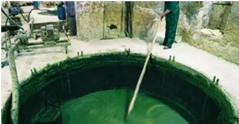
Figure 48 : Chaudron utilisé pour la saponification (167)
