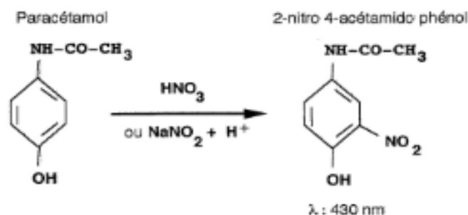
Figure 7 : Technique colorimétrique du dosage de la paracétamolémie
