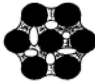
Figure 22 : Représentation schématique de ponts liquides mobiles entre particules de poudre
