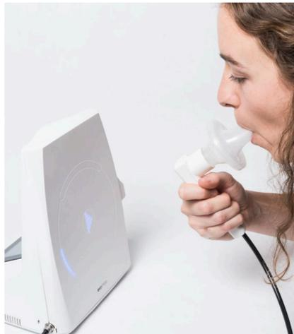
Figure 41 : Appareil de mesure du Monoxyde d'Azote(259)
