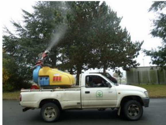
Figure 26 : Canon atomiseur monté sur un pick up (58)
