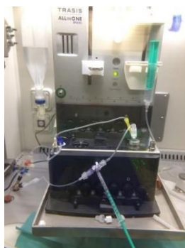
Figure 43 : Montage pour le radiomarquage du ^{68}\text{Ga} -DOTATOC
