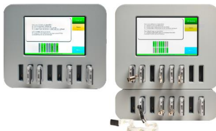
Figure 27 : Exemple de dosimètres opérationnels placés sur leur borne
