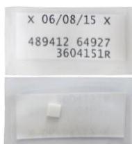
Figure 25 : Pastille TLD avec étiquette d'identification scellée dans le sachet
