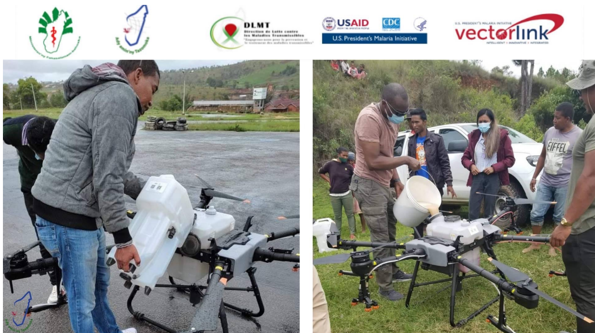
Figure 21 : Épandage de produits larvicides par drones dans les champs agricoles aquatiques (49)
