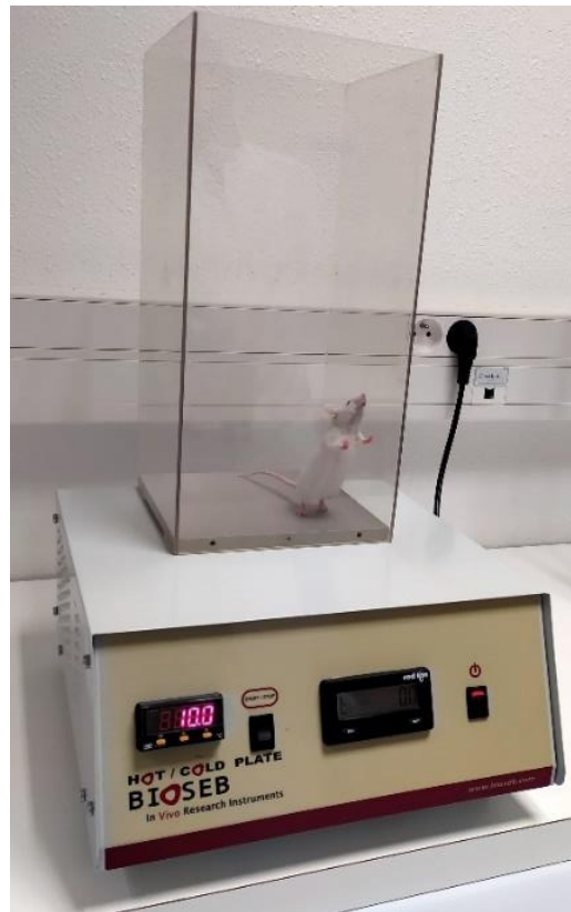
Figure 19 Photo du dispositif d'évaluation de la sensibilité thermique au froid
