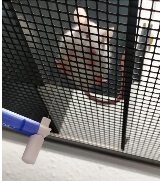
Figure 18 Photo du dispositif d'évaluation de la sensibilité tactile des souris
