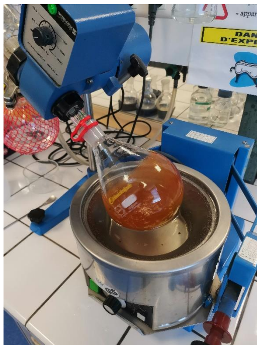
Figure 24 : évaporation de la phase butanol pour obtenir un extrait sec
