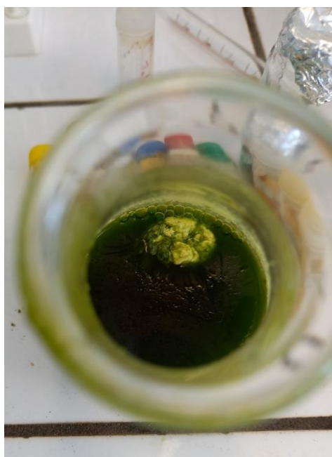
Figure 27 : acétone faisant précipiter la solution
