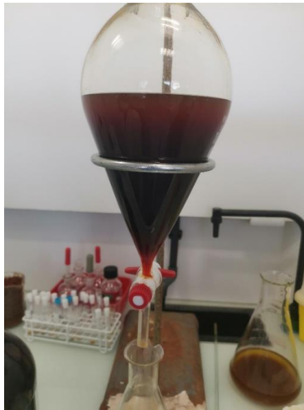
Figure 23 : extraction liquide/liquide avec l'acétate d'éthyle
