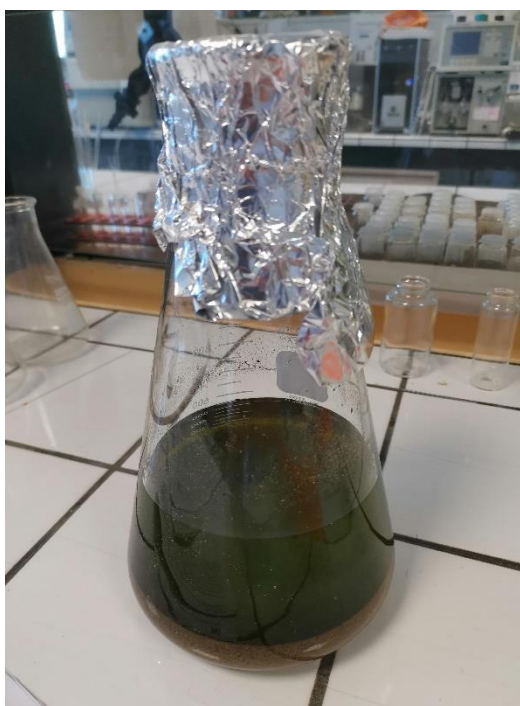
Figure 25 : solution après agitation barreau aimanté (méthanol et poudre de rhizome)
