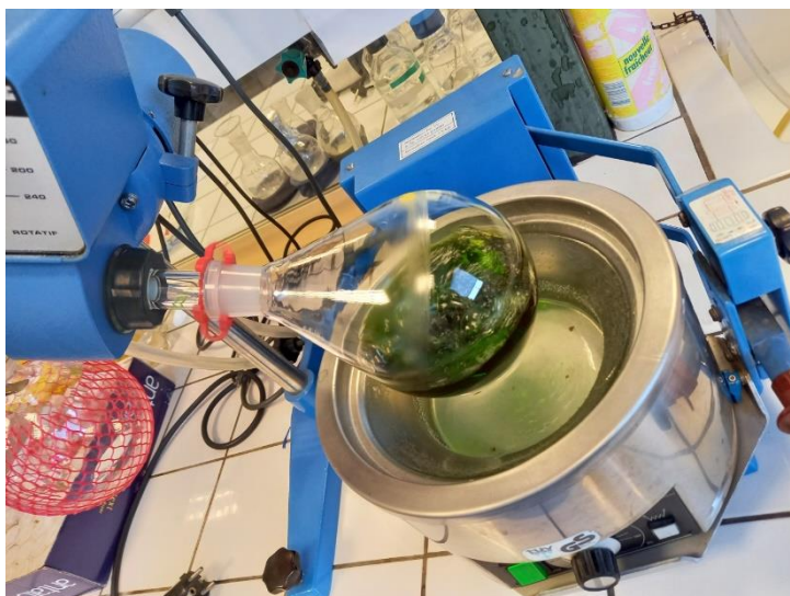
Figure 26 : évaporation rotative de la solution méthanol/poudre de rhizome
