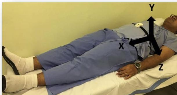
Photo 5 : Positionnement du capteur portable au niveau du sternum
