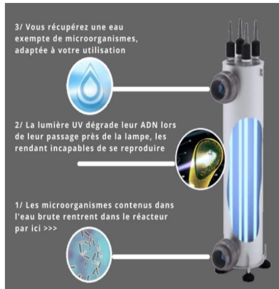
Figure 89 : Principe de désinfection UV. (234)
