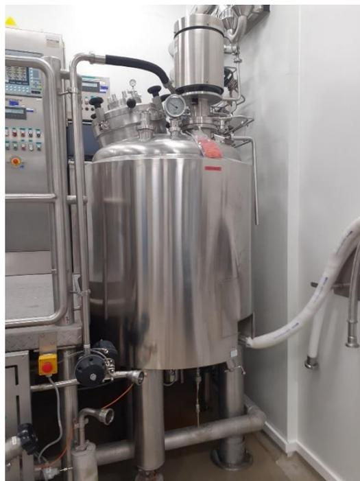
Figure 48 : Cuve de stockage avec une pompe de répartition
