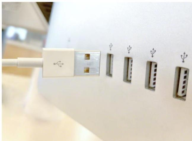
Les câbles USB sont un Poka-Yoke car, pour fonctionner, ils ne peuvent être insérés que dans un sens
