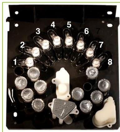
Figure 13 : Chambres indépendantes de PCR (intérieur de la cassette de réaction)
