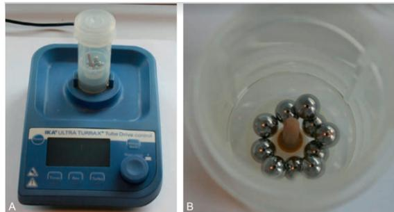
Figure 6 : Broyeur-homogénéiseur Ultra-Turrax (A) et flacon comportant des billes mécaniques (B)
