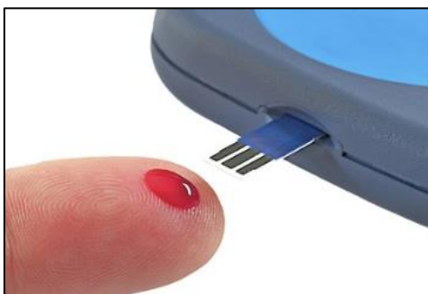
Figure 29 : Aspiration d'une goutte de sang par capillarité (43)
