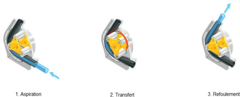
Figure 2 - Principe de fonctionnement d'une pompe péristaltique
