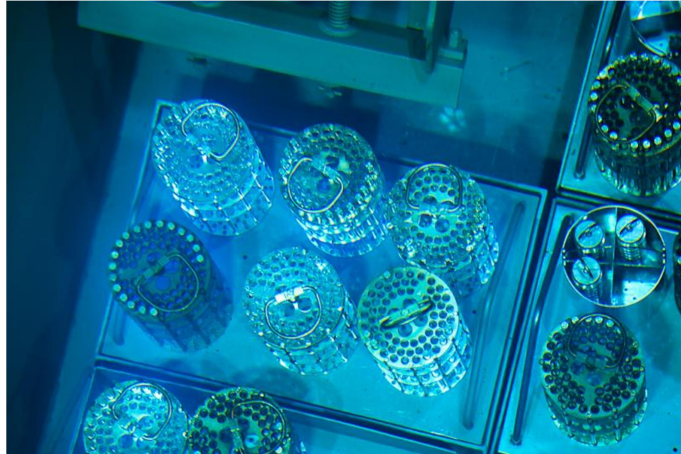
Figure 5 : Stérilisateur par rayonnement gamma alimenté par du \text{Co}^{60}
