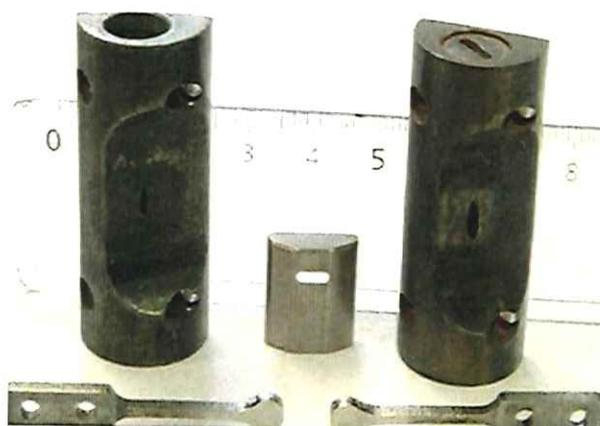
Figure 23 : Cheminées d'extraction de l'ion source
