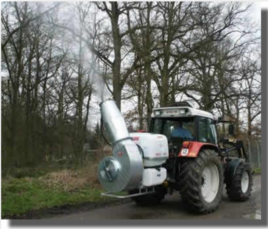
Figure 21 : Exemple d'un traitement "au canon" (source France chenilles)
