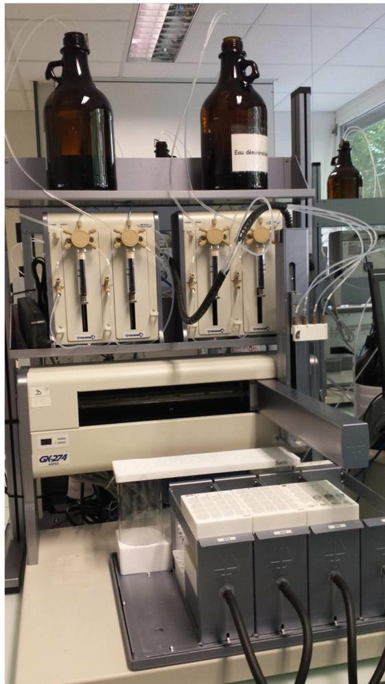
Figure n° 50 : matériel permettant l'extraction sur phase solide.
