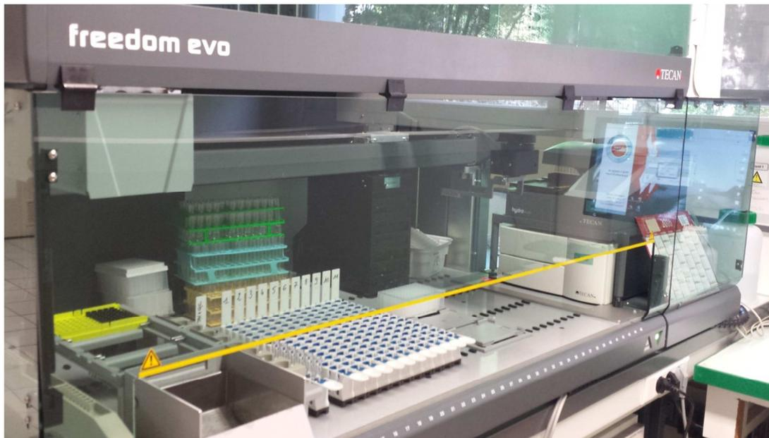
Figure n° 58 : Matériel permettant la réalisation de test ELISA
