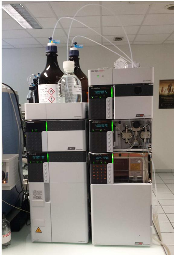
Figure n° 53 : Chromatographe liquide haute performance
