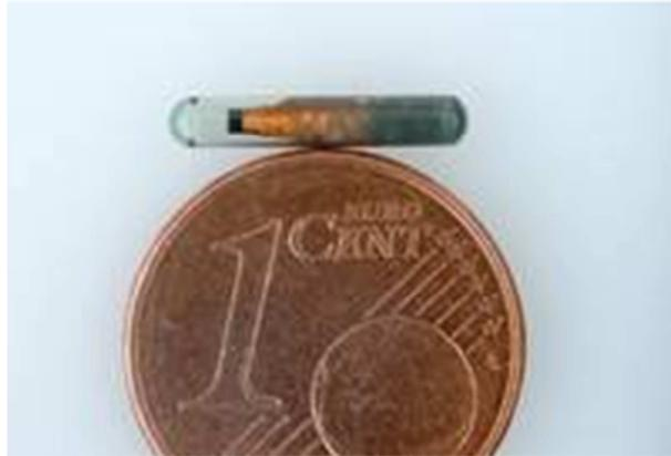
Figure n°2 : Photo d'un transpondeur
