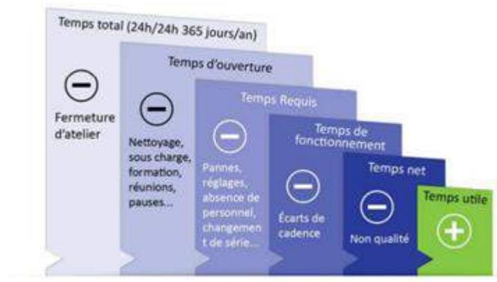
Figure 28: Décomposition des temps pour le calcul du TRS [22]
