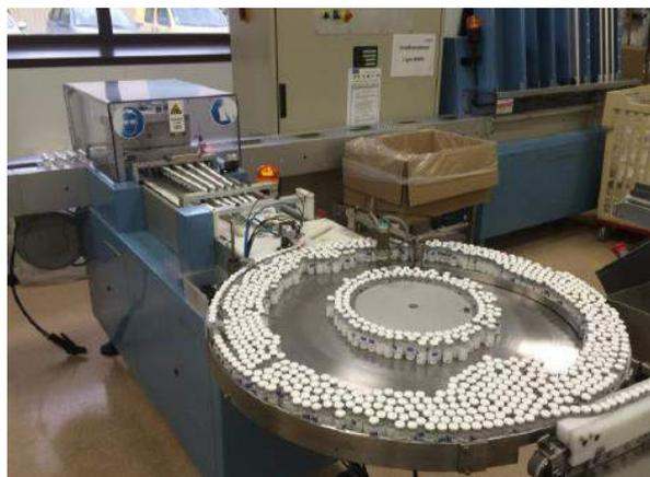
Figure 30: Système de répartition des flacons en sortie de Libra (avec la table tournante au premier plan)
