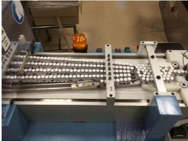
Figure 31: Système de rails convoyant les flacons vers le bras manipulateur
