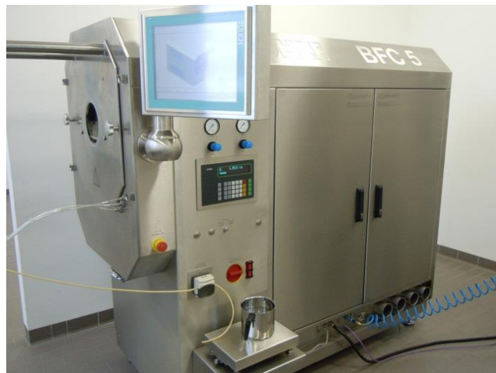
Figure 10 : Turbine perforée d'enrobage Böhle BFC 5
