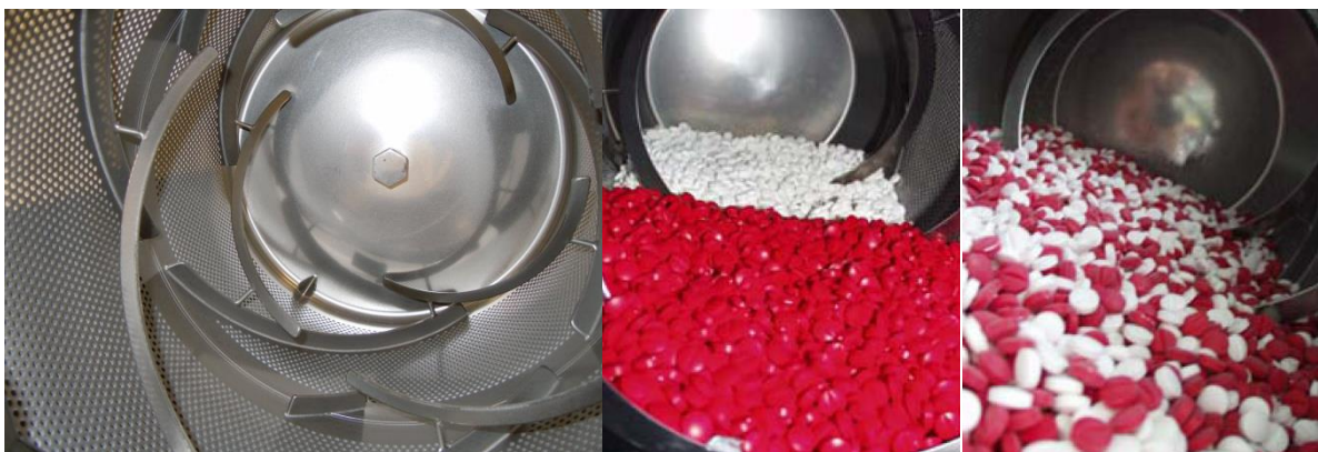
Figure 18: Intérieur du tambour et photo prise avant mélange de comprimés colorés blanc et rouge puis après 1 minute de mélange à 35 rpm.
