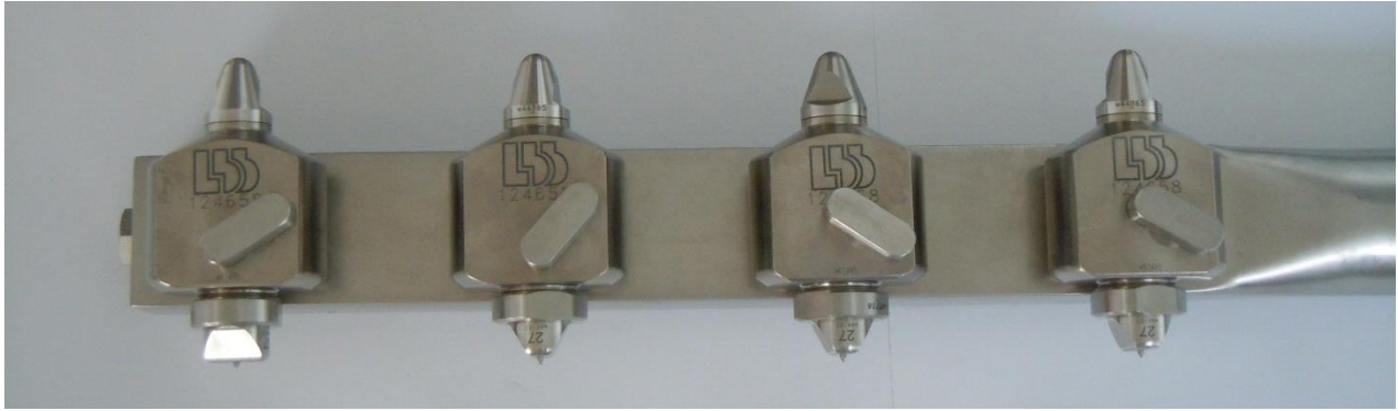
Figure 23: Bras de pulvérisation équipé des quatre pistolets Schlick® 970.
