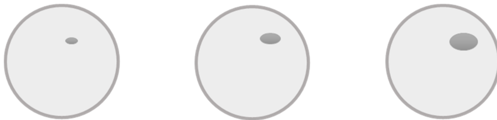
Figure 18 : représentation de la notion de sévérité appliquée au contrôle de présence de taches (24)
