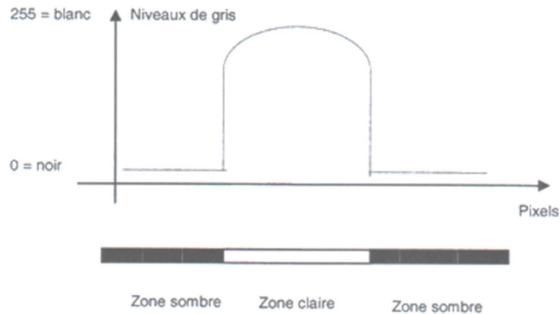
Figure 19 : exemple de courbe représentant un comprimé en fonction de ses niveaux de gris (24)
