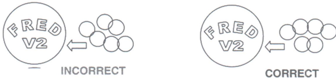
Figure 28 : illustration de la position angulaire d'un comprimé (24)
