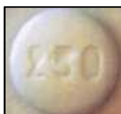
Figure 34 : éclat mineur, chaque caractère est lisible et l'éclat est inférieur à 3 mm
