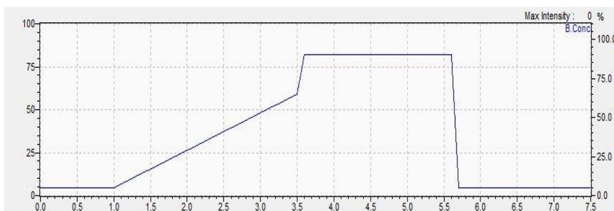
Figure n°30 : Représentation graphique du gradient de la phase B
