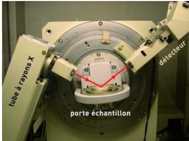
Figure 35: Principe d'un diffractomètre de rayons X [51]
