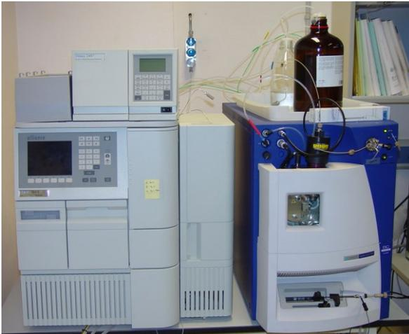
Figure 6 : spectromètre de masse et système chromatographique du Quattro micro de WATERS
