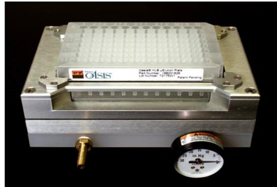
Figure 9 : Plaque SPE 96 puits et système d'aspiration de chez Waters.
