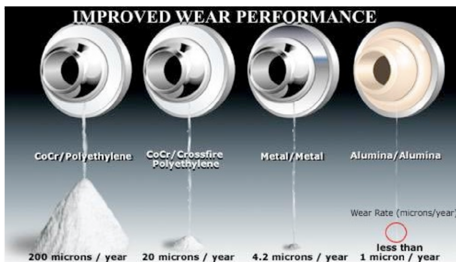
Illustration 10 : Comparaison schématique de la production annuelle en débris d’usure pour une année d’utilisation dans des conditions normales
