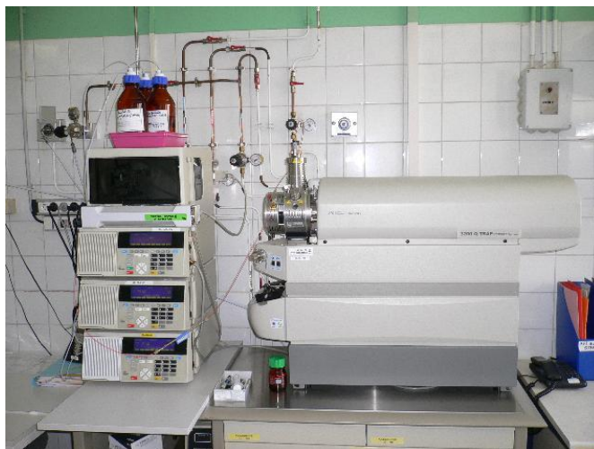
Figure 11 : Photo du montage CL-3200 QTRAP du service de pharmacologie, toxicologie et pharmacovigilance du CHU de Limoges.
