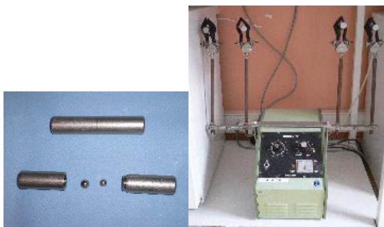
Figure 6 : Photos d'un broyeur à boulets et de l'agitateur oscillant.
