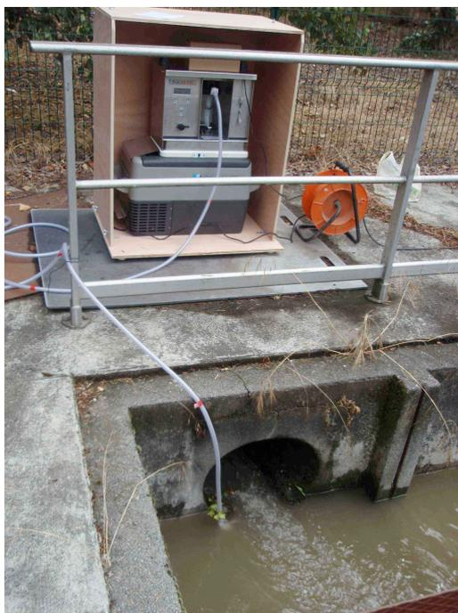
*Image 4 : Préleveur automatique et collecteur des effluents hospitaliers du CHU de Rangueil*
