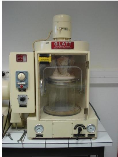
Figure 20: Photo du séchoir en lit fluidisé
