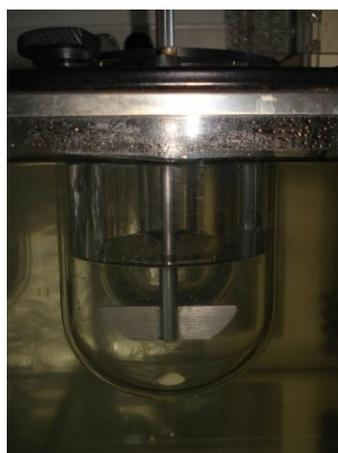
Figure 31: Photo d'un bol du Dissolutest
