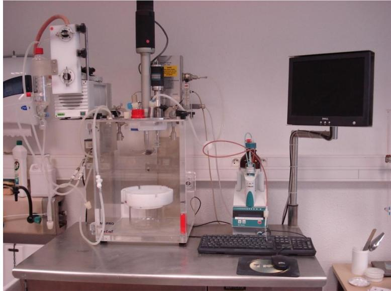
Figure 19: Photo du granulateur Mi-Pro
