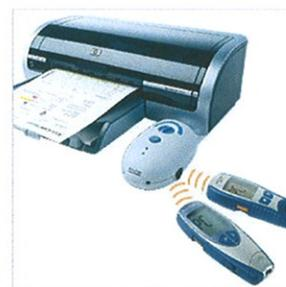
La transmission des données est réalisée par liaison infrarouge entre le lecteur de glycémie et le boîtier connecté à cette imprimante.
