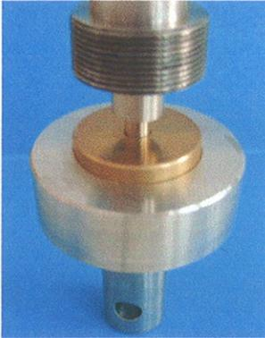
Figure 35 : Matrice + poinçon
