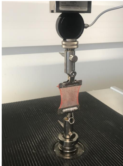
Figure 9 : Positionnement de l'échantillon testé entre les mors de la machine d'essai
