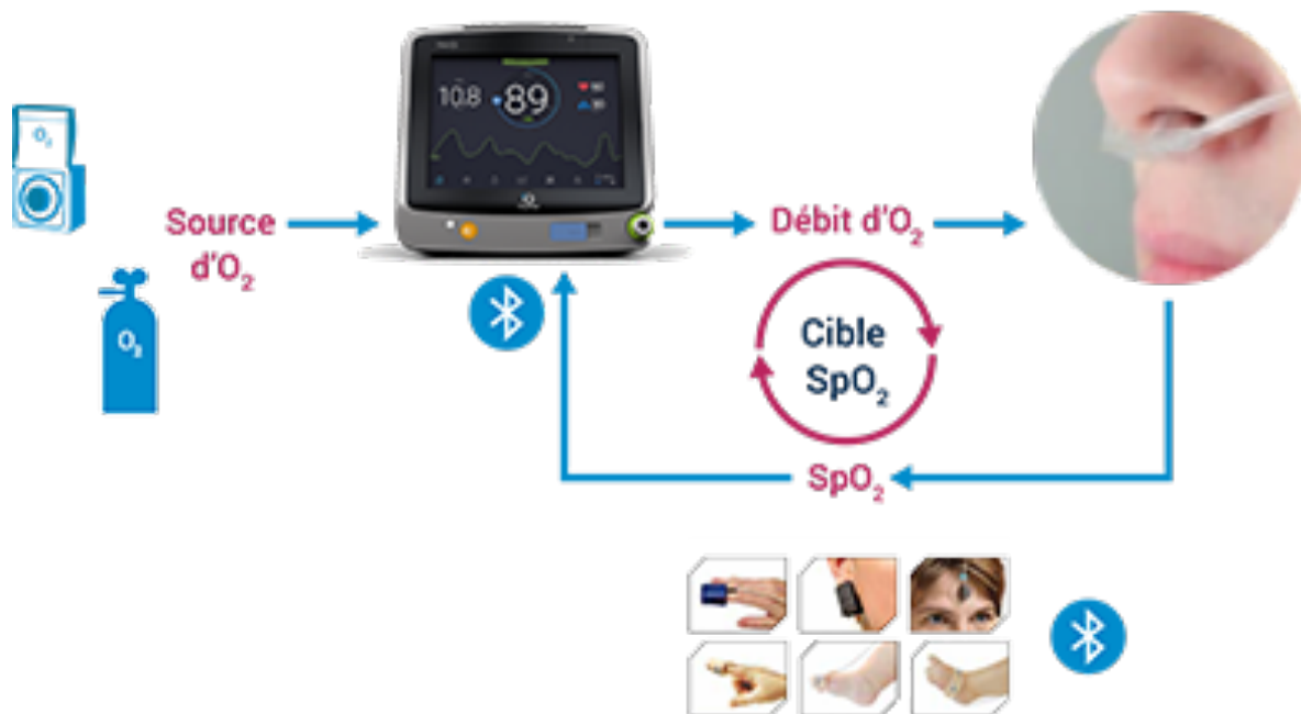
Figure 6 : Principe de fonctionnement du système FREEO2
