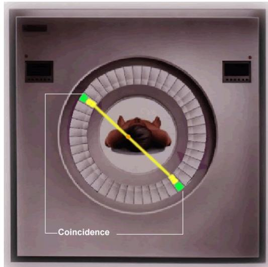
**Figure 4** : Les détecteurs d'un tomographe à émission de positons (d'après (69)).
