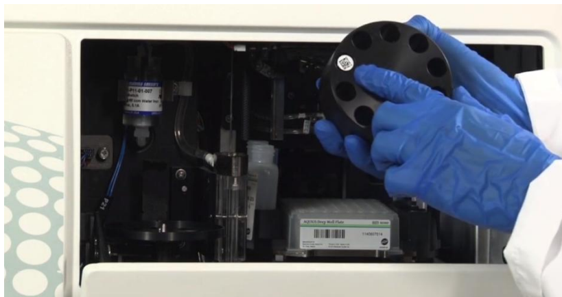
Figure 27 : Automate de CMF Aquios CL de Beckman Coulter ; réactifs suivis par codes barres 2D situés en dessous des flacons de mix
