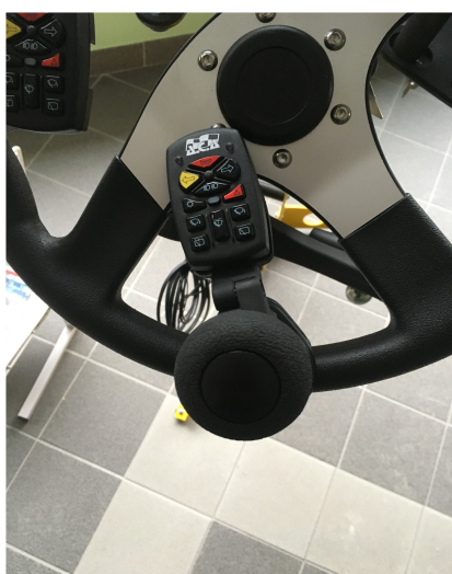
Illustration 8: Boule au volant avec télécommande pour les signaux d'alerte.
