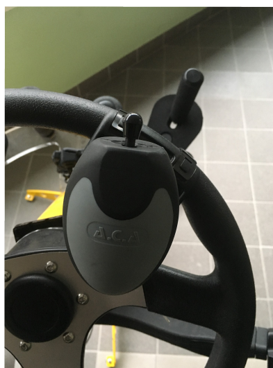
Illustration 6: Boule au volant équipée d'un joystick pour les commandes de clignotants.
