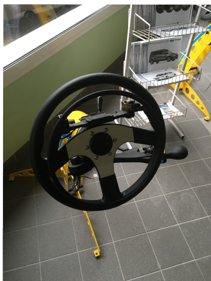
Illustration 5: Accélérateur par cercle au volant associé à une manette de frein.
