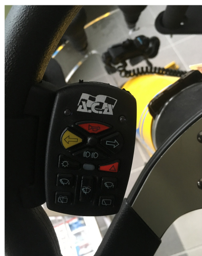
Illustration 9: Détail de la télécommande.
