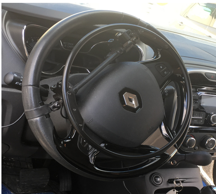
Illustration 10: accélérateur au volant
