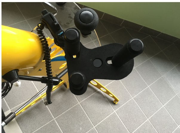
Illustration 7: Poignée directionnelle utilisée en cas de déficit moteur important des membres supérieurs.
