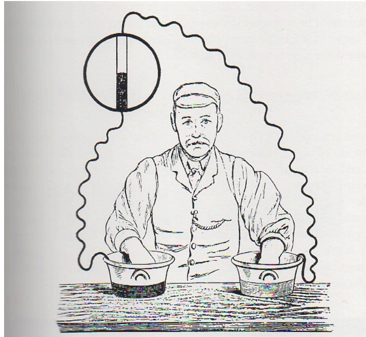
Fig-20. Sujet connecté à l'électromètre capillaire au moyen d'électrodes faites d'un récipient en métal contenant de l'eau salée (British Medical Journal, 1888)
