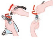
3. Raccorde le système. C'est très simple d'assembler les différentes parties, regarde... Le gris va avec le gris. Le bleu va avec le bleu. Ne tourne pas plus d'un demi-tour. Ne force pas.
