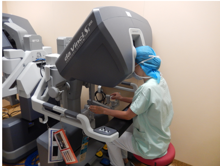
Figure 38 : Chirurgien positionné à la console du robot munie d'un écran 3D et de manipulateurs.
