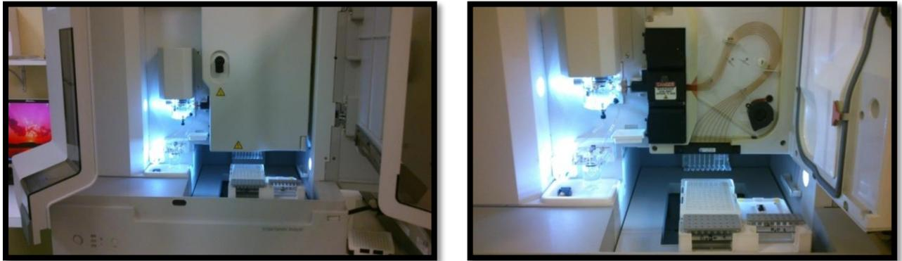
**Figure 8.** Représentation de l'analyseur ABI 3100, à gauche fermé, à droite ouvert mettant en évidence la plaque de séquence et les capillaires.
