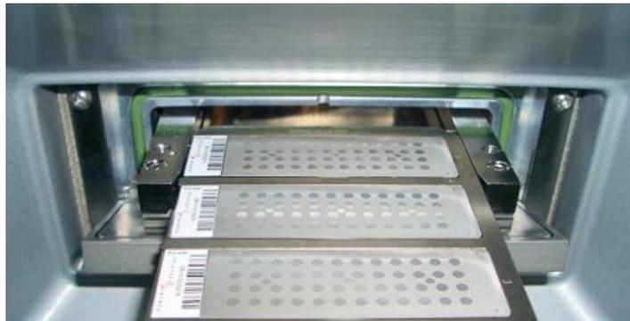
**Figure 15.** Chargement de l'adaptateur de cibles Vitek-MS DS dans le Vitek-MS<sup>®</sup> (Biomérieux<sup>®</sup>).
