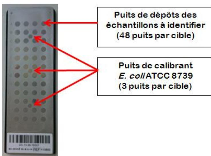
Figure 13. Représentation d'une cible VITEK-MS-DS<sup>®</sup> (Biomérieux<sup>®</sup>).
