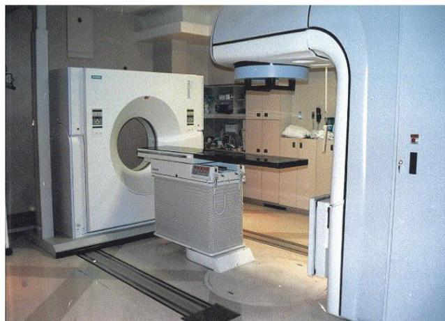
L'appareil de traitement associe un accélérateur linéaire et un scannographe mobile sur deux rails. La table sur laquelle est immobilisé le patient est commune au scanner et à l'accélérateur.
