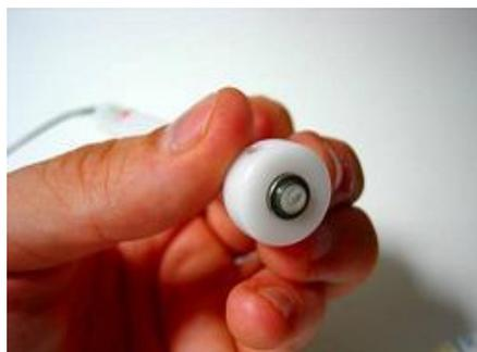
Figure 6 Transducteur de pression formé par la sonde Sphygmocor (source: AtCor MEDICAL)
