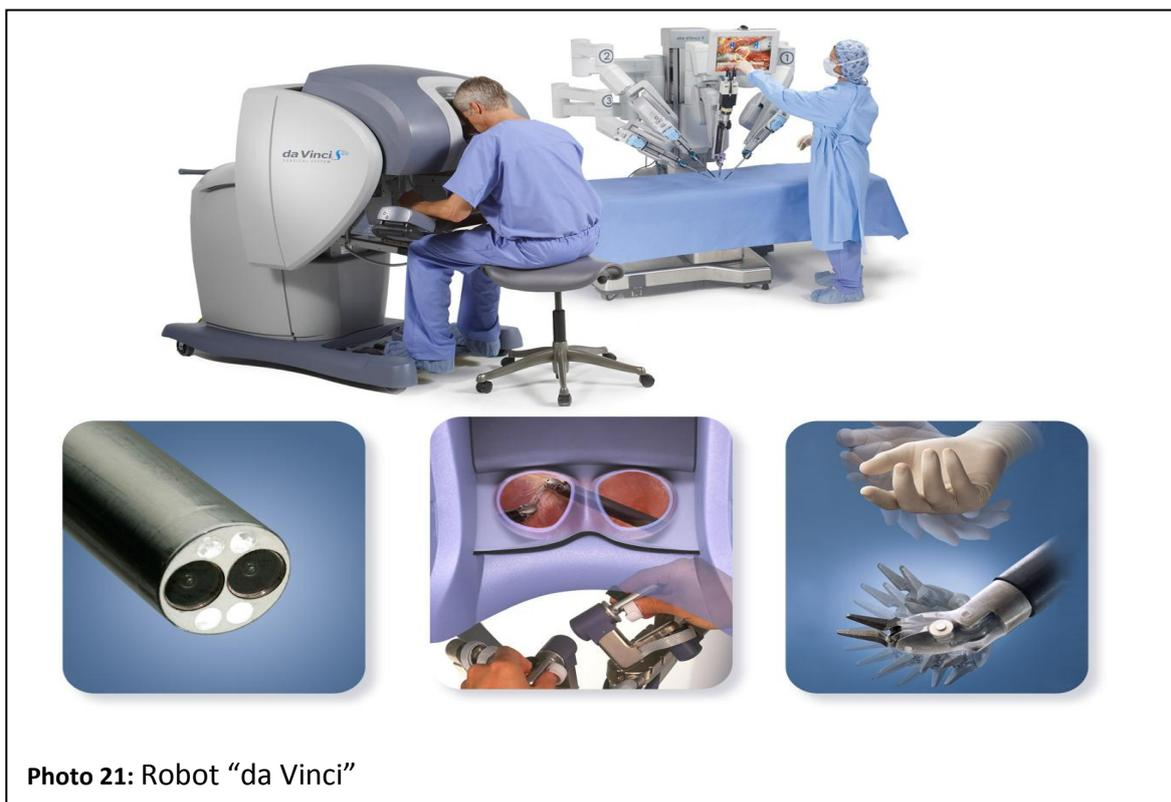
Un quatrième bras sera rajouté lors de l'actualisation du modèle en 2003 autorisant à l'opérateur un degré supérieur d'autonomie pour l'opérateur. De même en 2006, la vision tridimensionnelle passera en haute définition grâce à un système multi-écrans.
