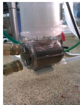
*Figures 15 et 16 : Générateur thermique et oxygénateur.*
