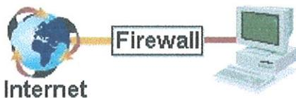
Le principe du Fire-Wall est de quantifier les échanges sur un réseau, et de les rendre traçables. Un échange qui n'est pas prévu (une intrusion par exemple) sera signalé.
